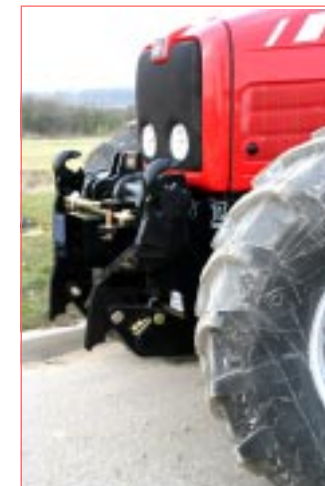
Compact: déport optimisé par rapport à la face avant
