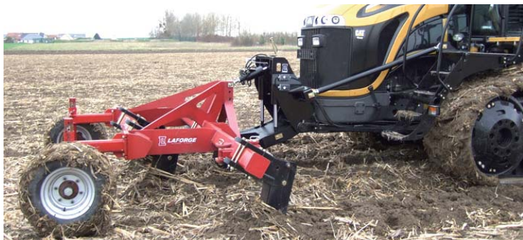
Relevage avant HDIT avec option DYNACONTOUR® attelé au décompacteur frontal UNIPASS®
