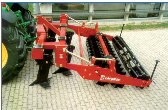
FLEXIPASS bi-poutre (avec rouleau barre + double mulch)
